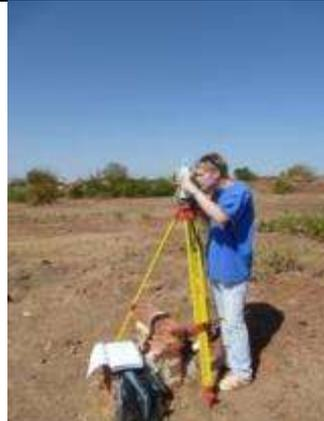
Levé topographique altimétrique et planimétrique des bornes, des arbres et également d'un nuage de points
